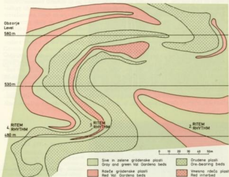
Sl. 14. Žirovski vrh. Prečni presek rudišča kaže ritmično zaporedje sedimentnih kamenin v dvojni S-strukturi
