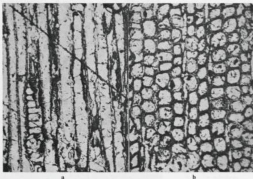
Sl. 34. Sebrelje. Piritna pseudomorfoza po rastlinskem ostanku. a) Tangencialni presek. b) Prečni presek. Odsevna polarizirana svetloba, 45 \times .
